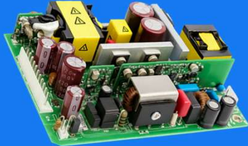
アシメトリZVS Flyback circuit 300W PFC
