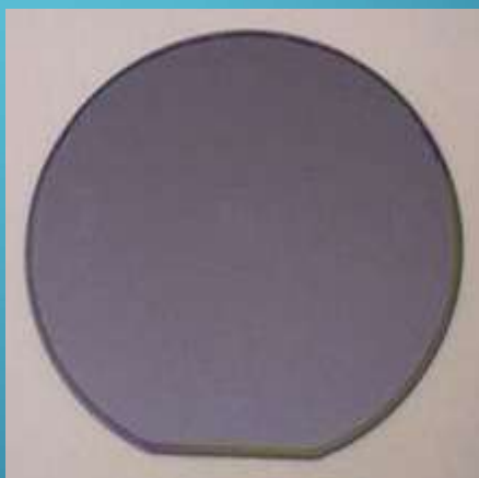
SOI ウエハ <1.5mm エッジテラス構造
