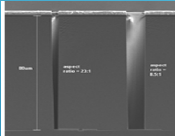
SOIウエハーにおけるアンダーカットのない隣り合う高、低アスペクトトレンチの加工例
