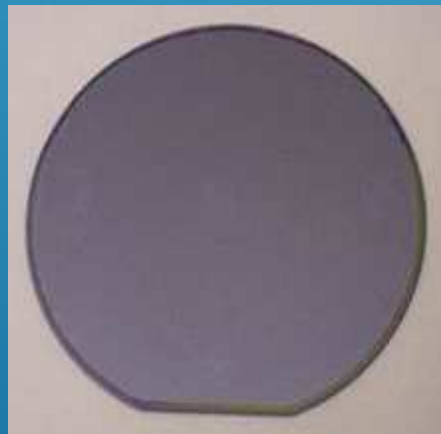
SOI ウエハ <1.5mm エッジテラス構造
